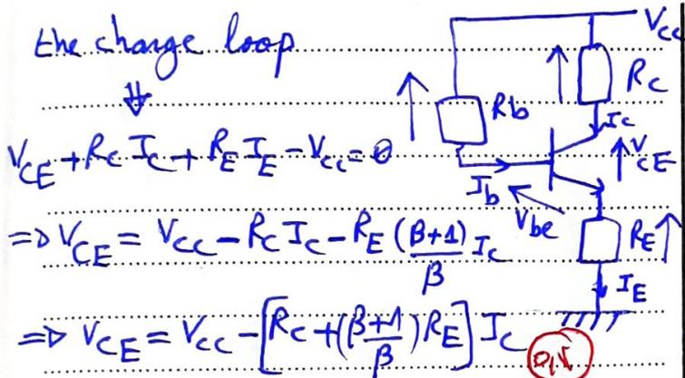
$$V_{CE} + R_C I_C + R_E I_E - V_{CC} = 0$$
